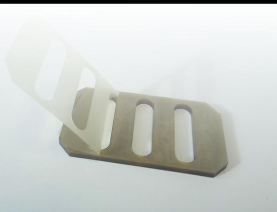
PEEKPEEL®<sup>(1)</sup> ist ein von LAMECO entwickelter schälbarer Verbundwerkstoff.
