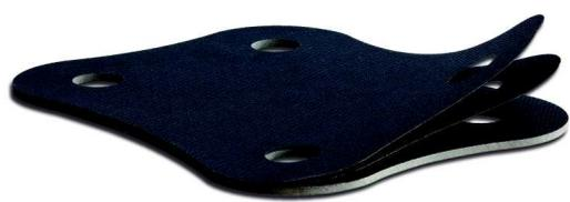
X.FIBER<sup>®(1)</sup> 是一种取得专利的复合材料产品，是层叠垫片行业的创新。该复合材料可由不同方式制造的纤维编织层制成——这些纤维可以是下列材料：玻璃、碳、芳纶、陶瓷纤维或2种或更多以上不同纤维的组合。该层压板材由热固化树脂粘结在一起，制成的材料具有卓越的技术性能和出色的可剥性。
