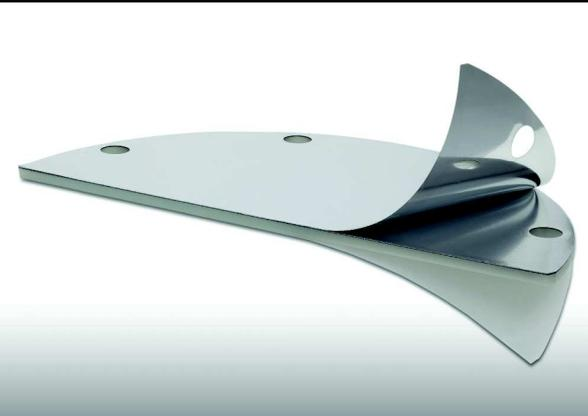
DUOPEEL<sup>®</sup> (1) 是由 LAMECO 设计的一种可剥复合材料 (2)。这种双层可剥的层叠复合材料令人非常容易区分其可剥层的不同厚度。这是因为最薄的薄片经过了特殊处理，使肉眼也可以识别：聚酯薄膜表面覆盖了一层铝原子，使其具有金属般的外观。而最厚的薄片是单色聚合物，因此可以识别成品的不同可剥层。这样您就可以选择适当的面进行剥离，从而快速获得所需要的精确垫片厚度。
