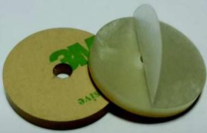
PEELSTICK®层叠垫片<sup>(1)</sup>的一侧贴有双面胶贴。使用时只需要取下保护层就可以准确地将垫片贴在需要调整厚度或填塞垫片的位置。双面胶具有高粘接强度和出色的耐环境性能。
