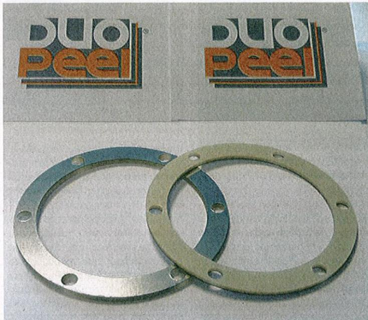
Der doppelt laminierte Kompositwerkstoff ermöglicht leichte Unterscheidung verschiedener Lamellendicken.
