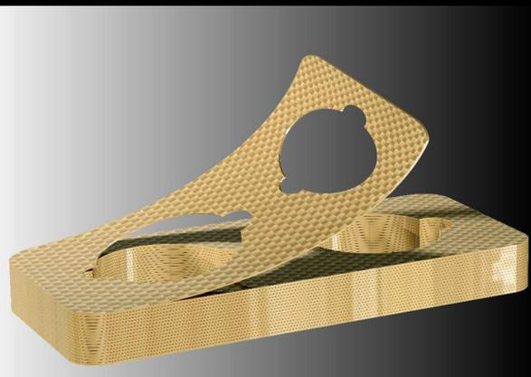
X.FIBER HIGH-DENSITY<sup>® (1)</sup> ist ein von Daniel GASTEL entwickelter schälbarer Werkstoff<sup>(2)</sup>. Dieser Verbundwerkstoff besteht aus einer Vielzahl an Folien aus gewebter Glasfaser. Die Folien sind untereinander mit Duroplast verbunden, deren Verarbeitung dem somit erhaltenen Endwerkstoff technische Höchstleistungen und eine hervorragende Schälbarkeit verleiht.
