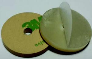
Ein doppelseitiger Aufkleber wird auf eine der Flächen der schälbaren PEELSTICK®-Passscheibe<sup>(1)</sup> aufgebracht. Es reicht somit aus, die Schutzfolie zu entfernen, um die Passscheibe genau an die Stelle zu kleben, an der der Dickenausgleich oder die Kompensierung erfolgen soll. Die doppelseitigen Klebeflächen besitzen eine hohe Endhaftung und eine sehr gute Beständigkeit gegenüber den Umgebungsbedingungen.
